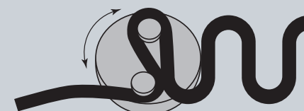
Einzigartige formende Oszillation mit nur zwei Biegebolzen vereinfacht die Wartung und die Bedienung.
